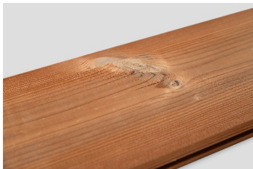
Допускаются незначительные трещины на поверхности
