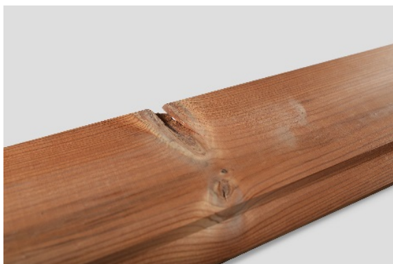
Большие трещины в местах сучков
