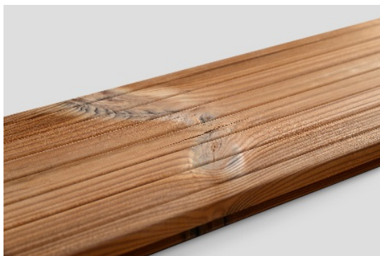
Допускаются незначительные трещины на поверхности
